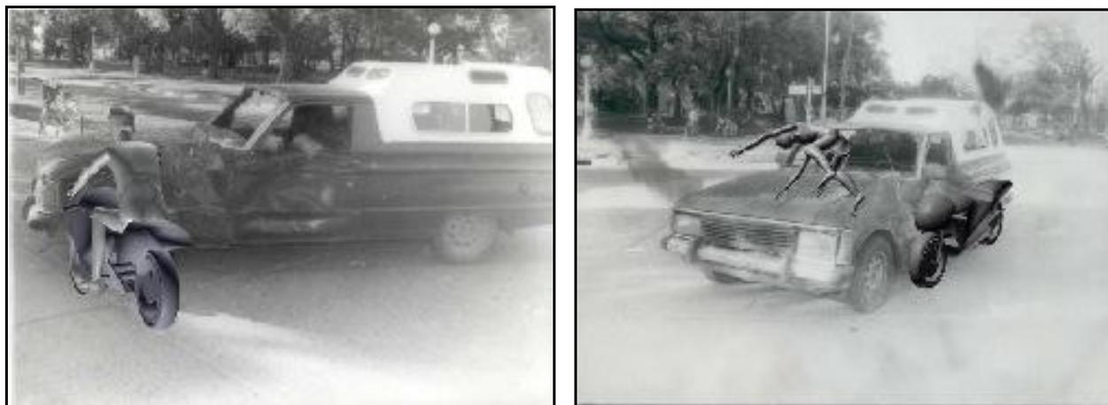
Figura 2 y Figura 3: ilustración de imágenes montadas sobre las fotografías del expediente, confrontando los daños de la camioneta con la formas de impacto de la motocicleta con su frente y su costado (segunda colisión).
