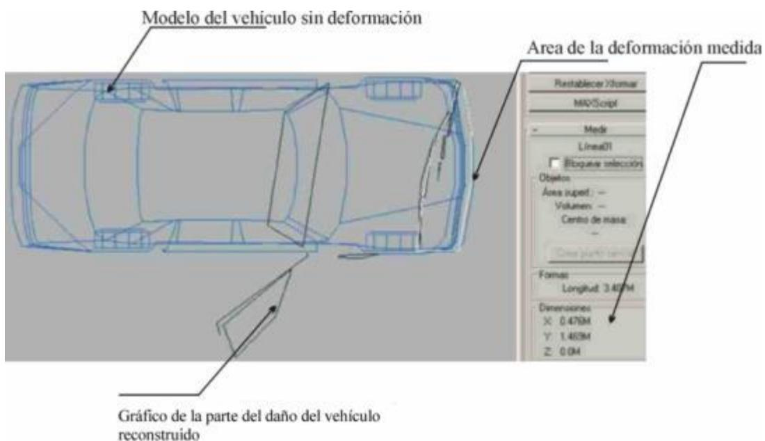
Figura.2: Superposición de los modelos en 3D Studio ®
