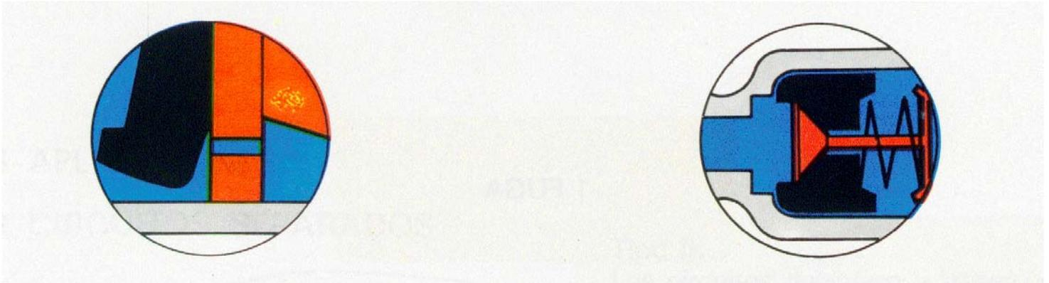
1.-La depresión en la cámara de la bomba tiende a retener la copela primaria en su movimiento de retorno y deformar los labios.
