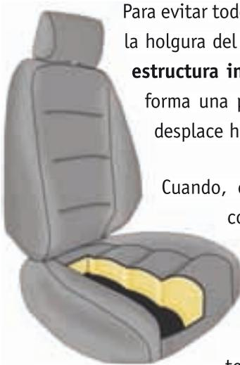
Para evitar todo ello, además de los mecanismos que eliminan o limitan la holgura del cinturón (pretensores), se hacen **modificaciones en la estructura interior del asiento**. La parte delantera de la banqueta forma una pequeña rampa, que hace más difícil que el cuerpo se desplace hacia adelante y hacia abajo.
