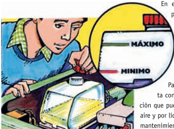
En el interior del motor se pueden alcanzar temperaturas de 2000 grados, temperatura que puede producir la fusión de las piezas del motor y, por consiguiente, el gripaje entre las piezas. Para evitarlo el motor cuenta con un sistema de refrigeración que puede ser de dos tipos: por aire y por líquido. Las operaciones de mantenimiento serán:
