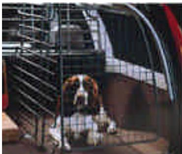
Además de la red de contención mencionada, **algunas terminales utilizan una estructura tubular de aluminio con forma de reja, como dispositivo de seguridad de serie en los vehículos tipo familiar o en las camionetas 4x4.**
