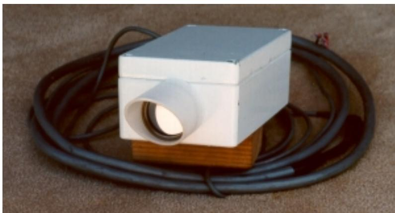
**Figure 26. Eltec 842 passive infrared sensor.**
