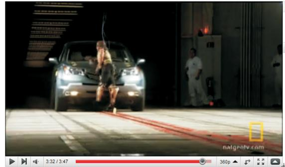
El video (en inglés) nos muestra las investigaciones llevadas a cabo en pruebas simuladas de atropellos de peatones a una velocidad de 40 km/h.
