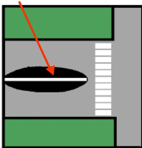
Separan la calzada en dos partes, formando dos sentidos de dirección de los vehículos. Esta línea también se llama eje de calzada. Los vehículos no deben adelantar cuando hay línea continua o eje de calzada.
