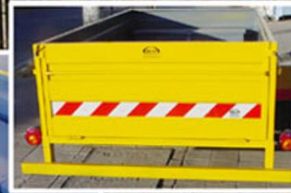
Medidas exteriores (c/lanza): 1670 x 3700 mm
